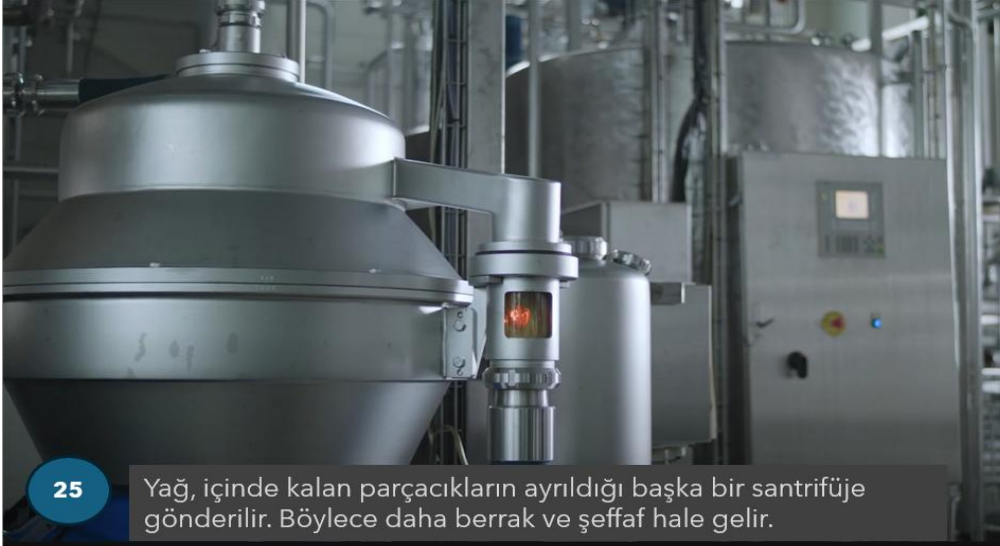
Foto: 23. Hidroliz tanklarına geri dönersek, geriye kalan protein ve yağ kalır çözeltisi hidroliz işleminden çıkıp, santrifujda birbirinden ayrılır ( Foto 24 )
