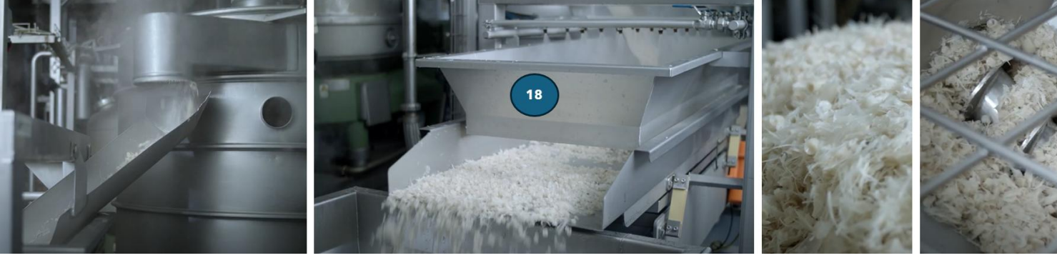
Foto 18: İşlemden ilk çıkan ürün kemiklerdir. Somon balığının kılçıkları ve omurgası bir filtreden geçirilerek ayrılır ve yıkandıktan sonra öğütme sistemine gönderilir.
