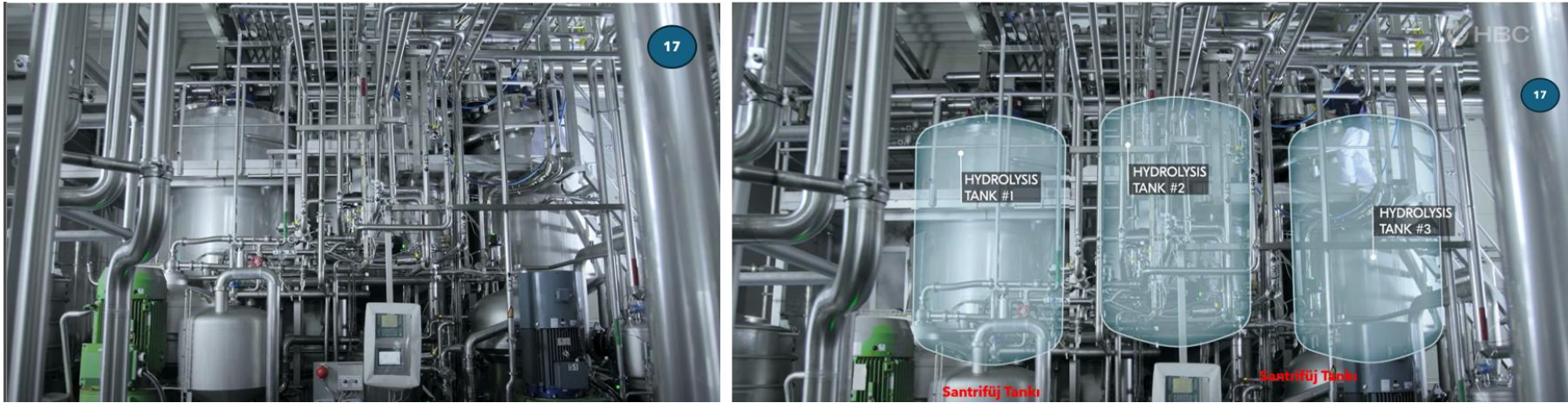
Foto 17: Parçalanmış sulu atık içine enzim eklenmesiyle hidroliz işlemine alınmaktadır. Hidroliz işlemi 3 farklı tankta ve sonrasında santrifüjde devam etmektedir. Her bir yüklemde 3 ton atık hidroliz işlemine alınmaktadır. Günde 3 tankta toplam 24 yükleme yapılmaktadır. Haftada 6 gün çalışan tesis yılda 20 bin ton atığı hidroliz etmektedir. (1 yüklemdeki malzemenin ortalama 3 saat işlem gördüğü ve her bir tankın yaklaşık 3 ton su ile karıştırılmış atık hidroliz ettiği anlaşılmaktadır. Firmanın bu tesisinin üretim kapasitesi, üretilen ürün cinsinden yıllık 1.000 ton olarak beyan edilmektedir. 2025 yılının Mart ayında firma yılda 2.500 ton protein hidrolizatı üreten tesisini Berkåk'da devreye almıştır). 94
