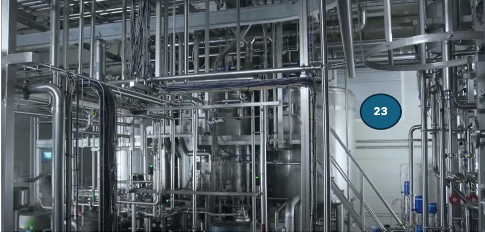
Foto: 23. Hidroliz tanklarına geri dönersek, geriye kalan protein ve yağ kalır çözeltisi hidroliz işleminden çıkıp, santrifujda birbirinden ayrılır ( Foto 24 )
